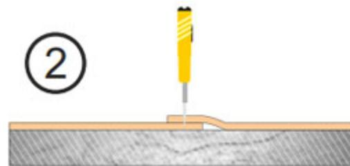
Прорежьте оба полотна до стены ножом
